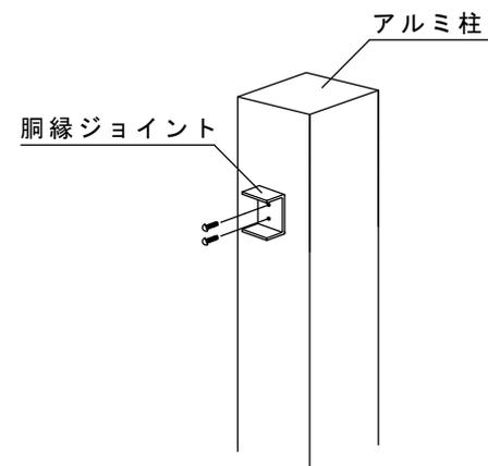
① 胴縁ジョイントを柱の内側に取り付けます。
