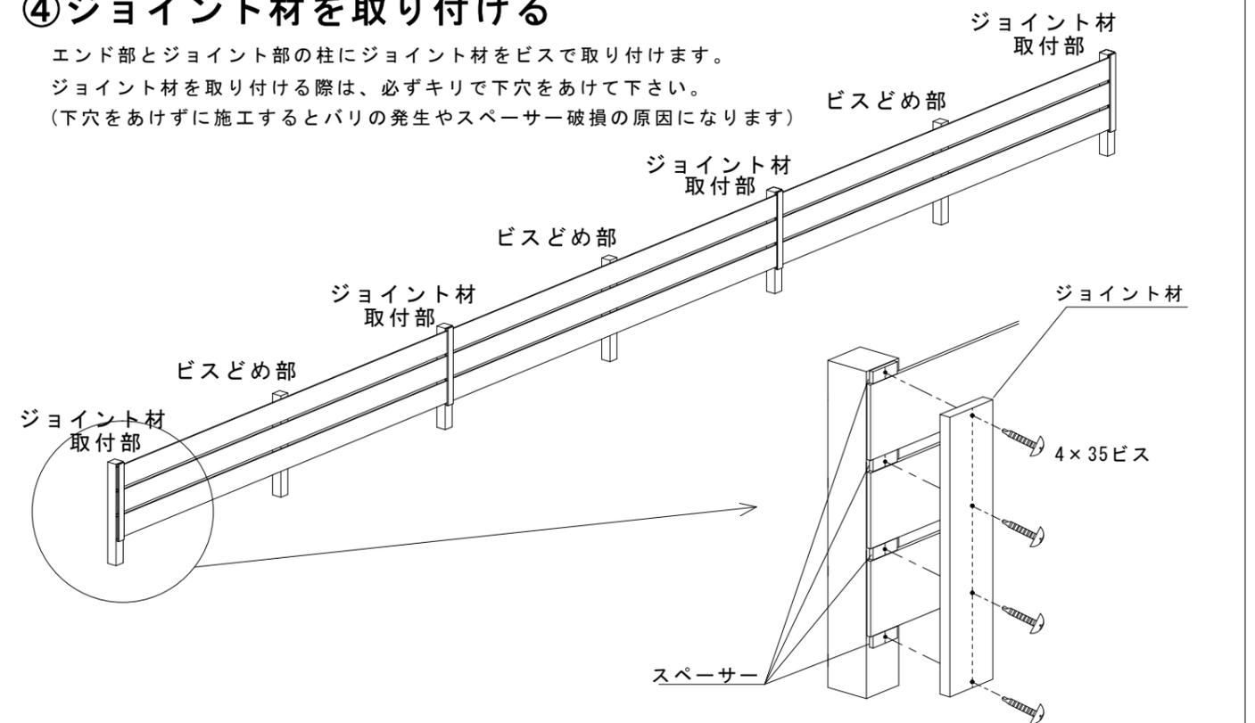
注：全長が5mや7mの場合、最後の柱がビスどめ部になります。(上記施工図は 全長が約6mの場合です)
